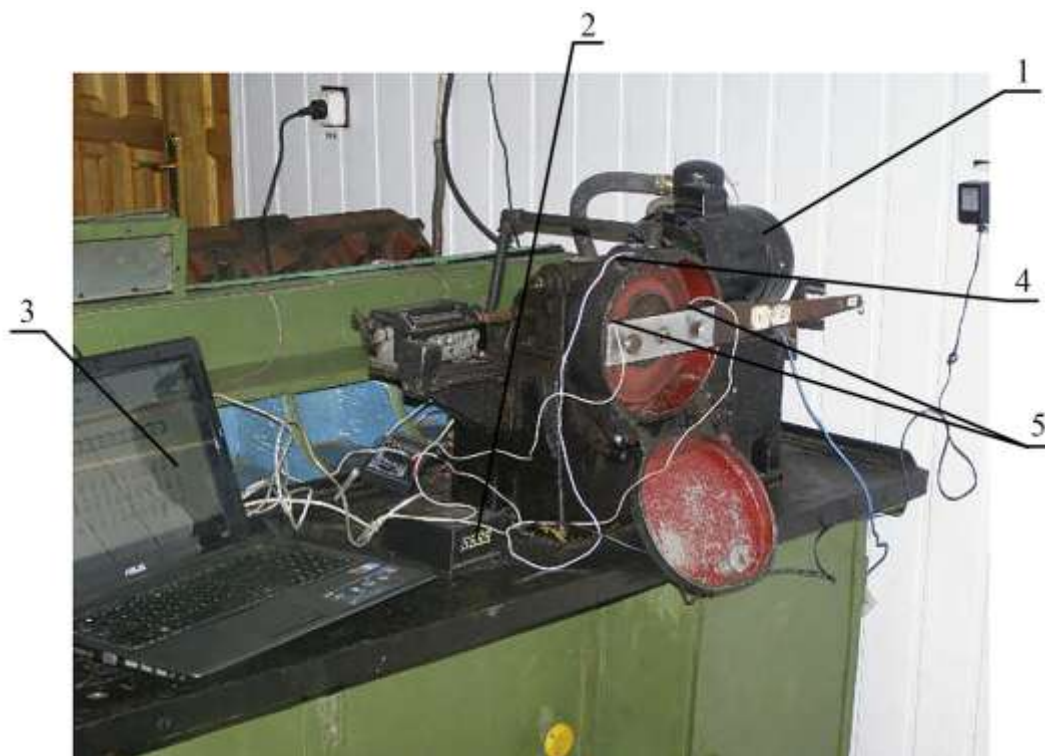
1 – машина тертя МИ-2, 2 – перетворювач, 3 – ПОМ, 4 – індукційний датчик обертів, 5 – термопари Рисунок 6 – Загальний вигляд експериментальної установки
